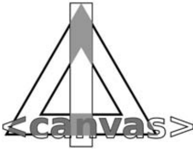
Рис. 21.13. Рисование контуров выполнено до, а заливка – после определения области отсечения
